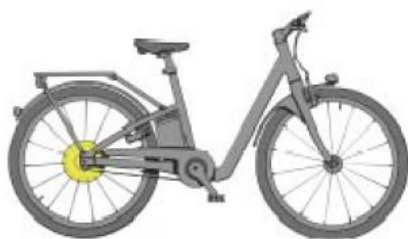
Motor elétrico alojado direto no cubo
