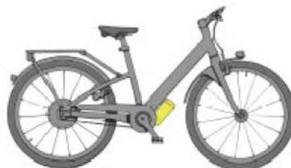
Motor elétrico alojado direto no movimento central
