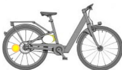
Motor elétrico alojado junto da catraca
